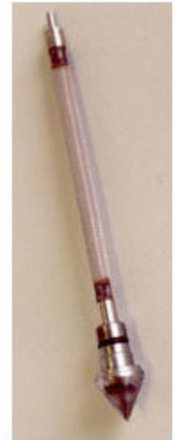
Campionamento mediante direct push, con punte campionatrici che giungono fino a 30 m di profondità.
