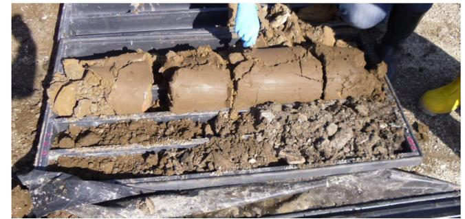
*Perforazione mediante carotaggio continuo a secco con carotiere semplice*
